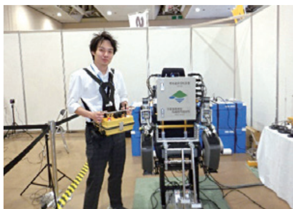
写真-2 模擬キャビンへのロボQS設置状況
