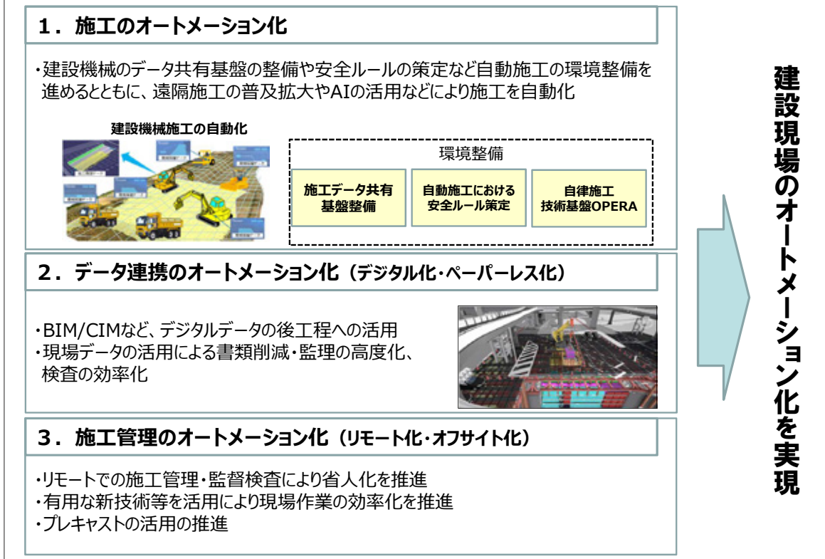
図－3 建設現場のオートメーション化に向けたトップランナー施策（3本柱）
