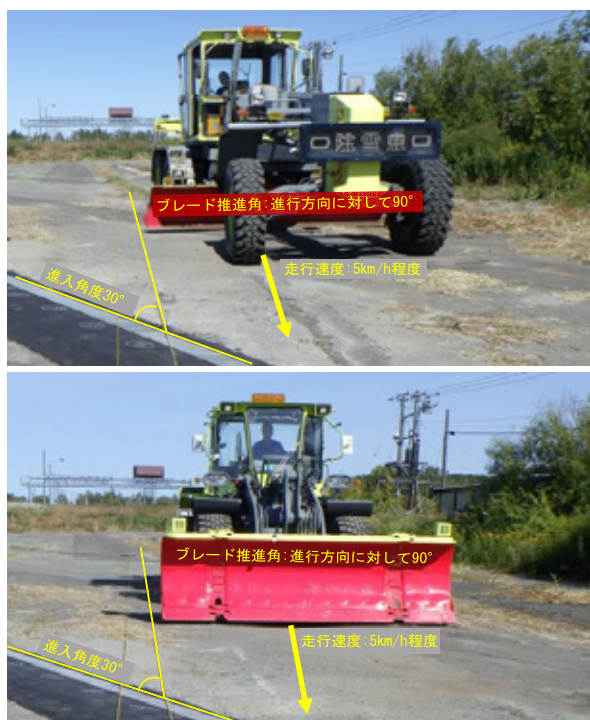
図-7 試験方法イメージ (上：除雪グレーダ、下：除雪ドーザ)
